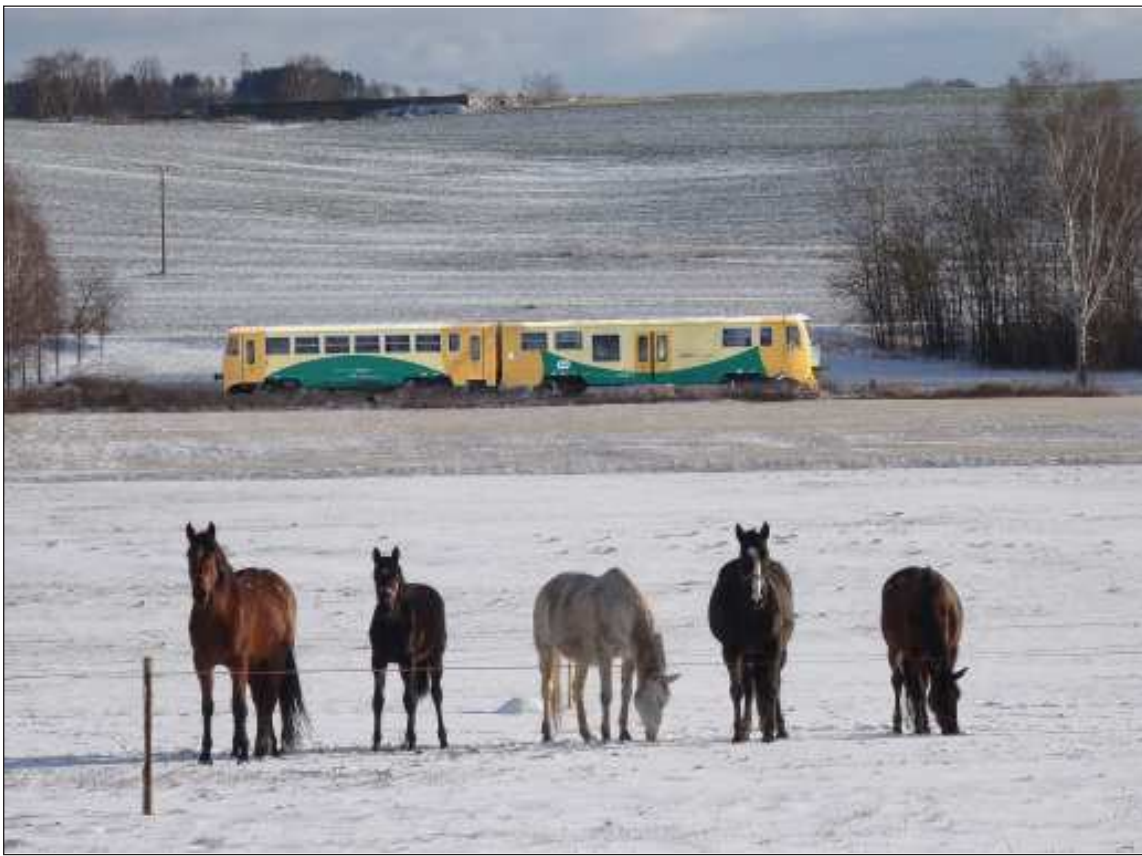
329 versus 5! Koňská síla je starší fyzikální jednotka výkonu, zavedená Jamesem Watterem. V přepočtu je koňská síla rovna 735,49875 W. Motor regionovy s výkonem 242 kW má tedy v přepočtu cca 329 koní. Snímek Michael Mareš
