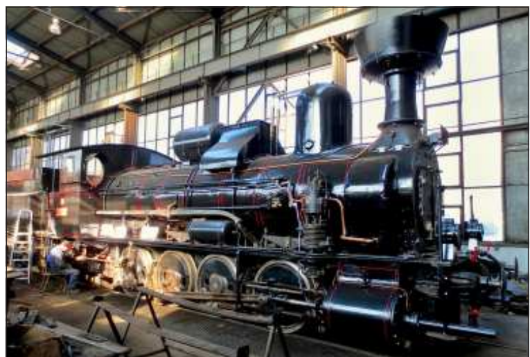
V opravárenské hale se dokončuje oprava „Heligónu“, parní mašinky 414.096 z roku 1906, kterou čeká letošní „velký parní návrat“ na koleje. Pracovník depa, pan Pavel Frič, dokončuje právě montáž rychloměru.
