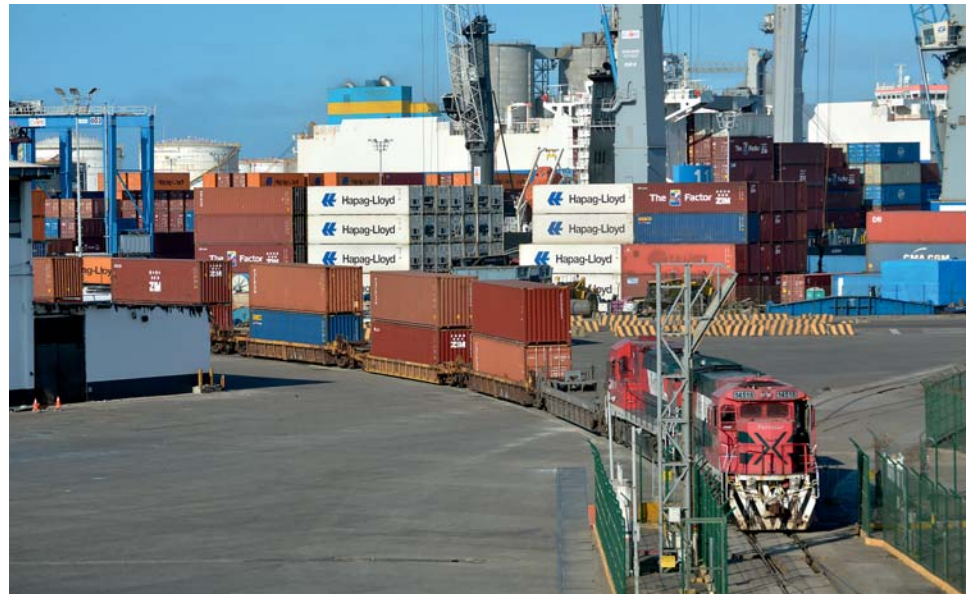
Posun se soupravou kontejnerových vozů ložených v severní Americe obvyklým doublestacku
