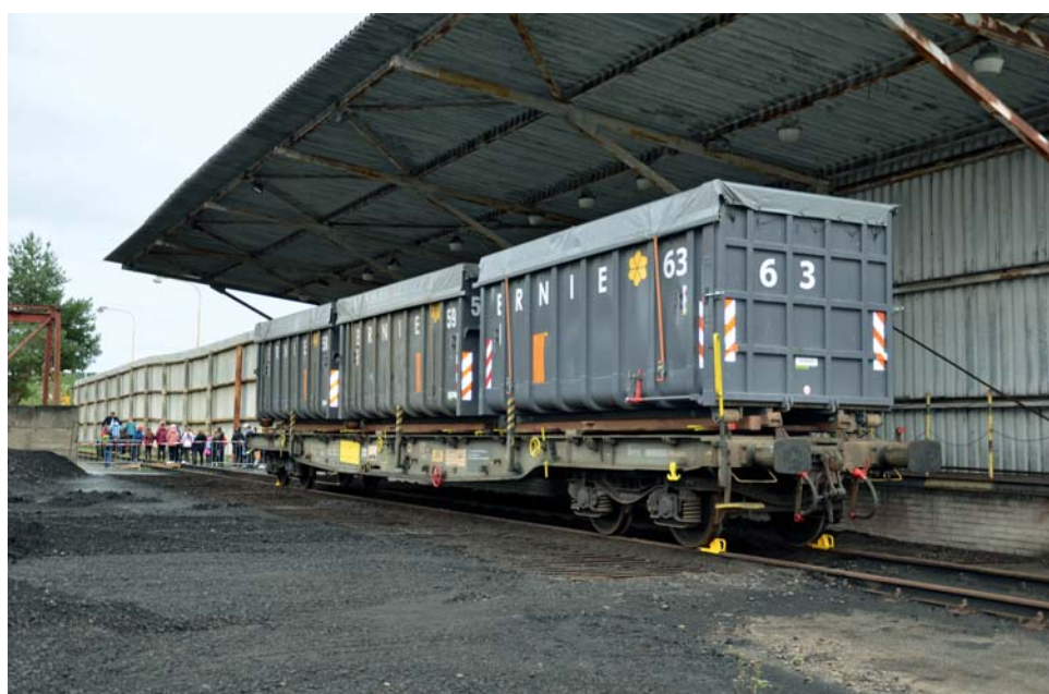
Na Dni pro zelené město v září 2022 prezentovalo ČD Cargo spolu s firmou Brnie železniční vůz s kontejnery ACTS určenými pro přepravu komunálního odpadu. FOTO: MICHAL ROH
