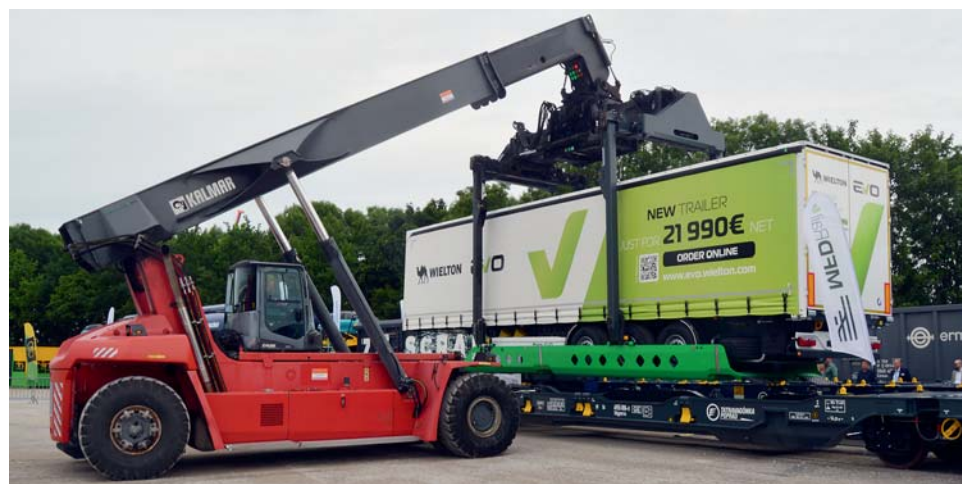
Překládka návěsu značky Wielton pomocí koše do vozu firmy Tatravagónka Poprad
