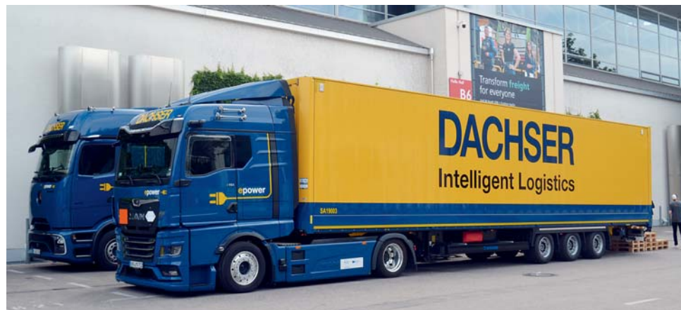
Elektrické bateriové tahače sloužící u logistického poskytovatele Dachser. Jeden značky MAN a druhý značky Mercedes.
