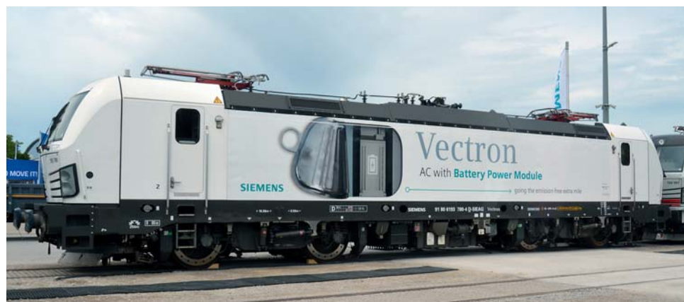
Duální lokomotiva Siemens Vectron s bateriovým pomocným pohonem
