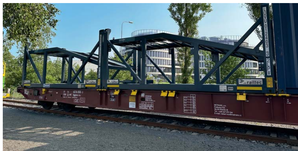
80stopý vůz řady Sggnss 80 se zajímavými „kontejnery“ na přepravu automobilů v expozici dopravce METRANS Rail
