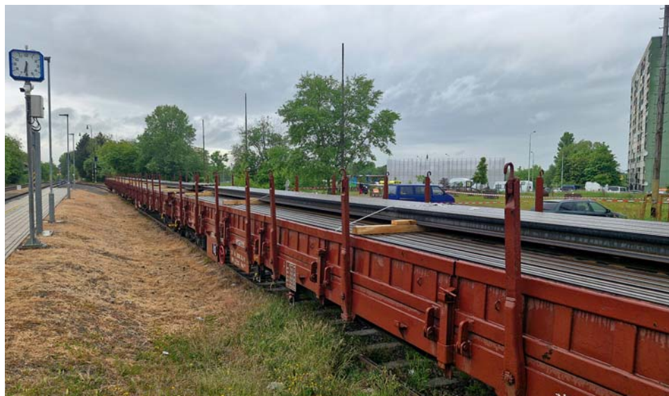
Vozy ložené kolejnicemi přistavené na manipulační kolej v železniční stanici Praha-Zličín
