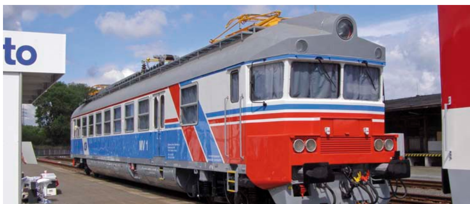
Modernizovaný měřicí vůz Výzkumného Ústavu Železničního, a.s. MV1
