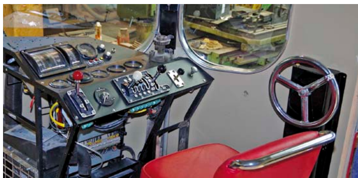
Stanoviště strojvedoucího krátce před dokončením prací v nymburských dílnách
