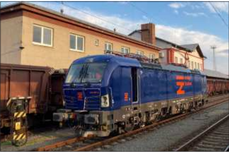
Lokomotivy Siemens Vectron mohou jako první typ v ČR provozovaných železničních vozidel plně využívat výhody jízdy pod dohledem ETCS. Snímek Správa železnic.
