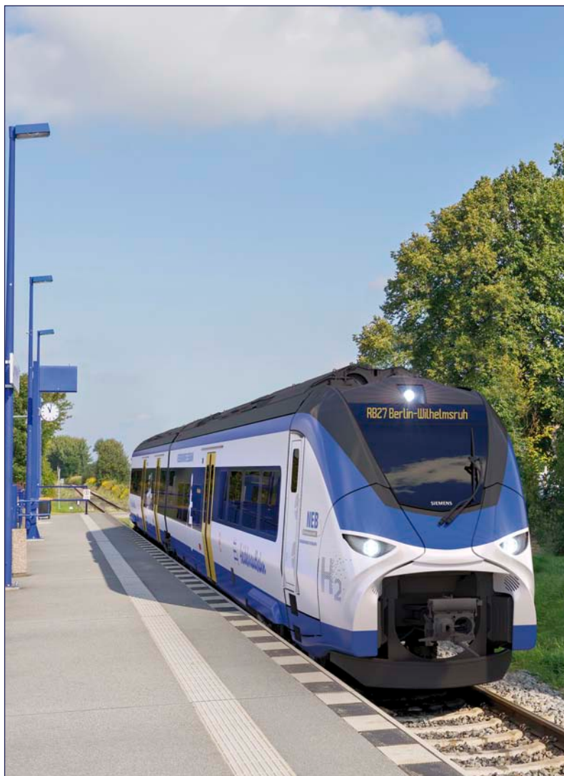
Společnost Siemens Mobility získala od společnosti Niederbarnimer Eisenbahn zakázku na dodávku sedmi dvouvozových jednotek Mireo Plus H pro síť Heidekrautbahn (RB27) v metropolitní oblasti Berlín - Brandenburg. Tato vozidla druhé generace nabízející přepravu zcela bez emisí CO 2 , jsou vybavena elektrickým trakčním pohonem napájeným z vodíkových palivových článků a z vyrovnávací lithium-iontové akumulátorové baterie.
