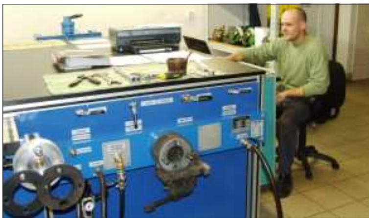
Vozový zámečník Petr Pospíšil u zkušebního stolu při zkoušení brzd DAKO.
