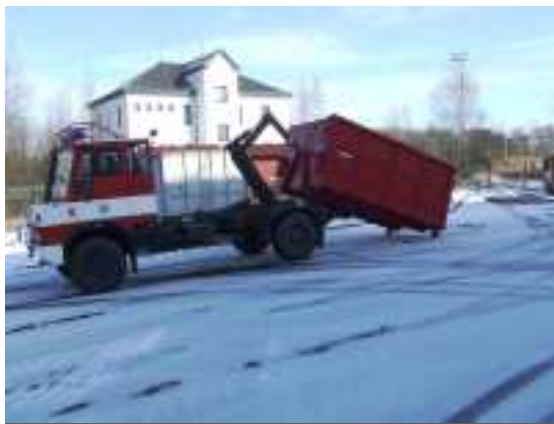
Díky kontejnerovému speciálu je možné operativně převážet kontejnery s potřebným vybavením na místo zásahu.
