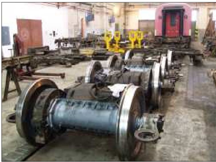
Podvozky typu Görlitz se opravují v jediné DKV Českých drah – v DKV Olomouc.
