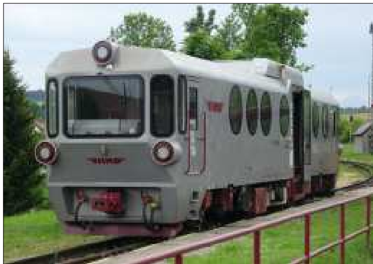
Rekonstruované motorové vozy z Rumunska, přezdívané Nautilus nebo Ponorka, jsou vysoké pro nástup a nejdou v nich stáhnout okénka.
