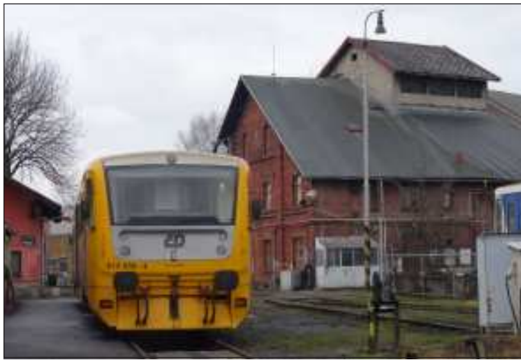
Motorová jednotka Regionova stojí nad prohlížecím kanálem před rotundou.
