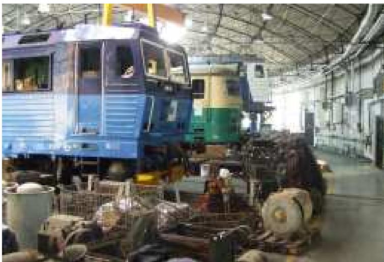
Záběr z kruhové haly DPOV Přerov, kde se provádějí vyvazovací opravy lokomotiv elektrické trakce vybraných řad.
