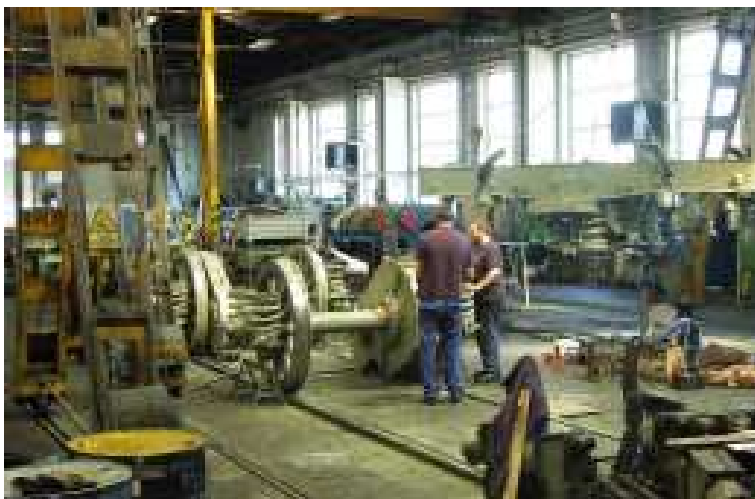
Mechanici DPOV Přerov v nové hale při práci na montáži lokomotivních podvozků.
