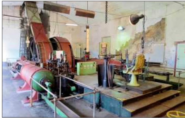
Jedním z nejzajímavějších exponátů je zde parní stroj z roku 1891, který neúnavně sloužil až do ukončení těžby v roce 1991. Po válce se k jeho pohonu používalo páry, přiváděné z nedaleké chemičky.
