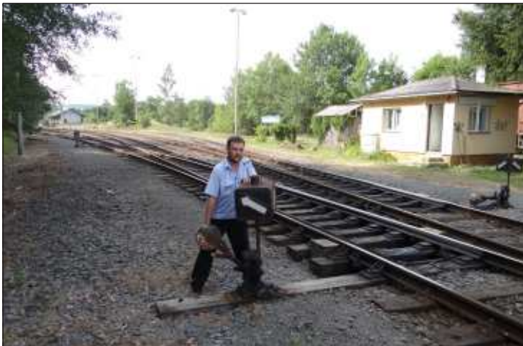
Dozorce výhybek Marek Ocela při stavění vlakové cesty místně stavěnou výhybkou.
