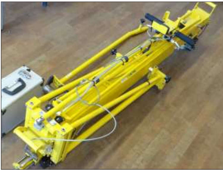
Měřicí zařízení kolejí KRAB ve složeném stavu.
