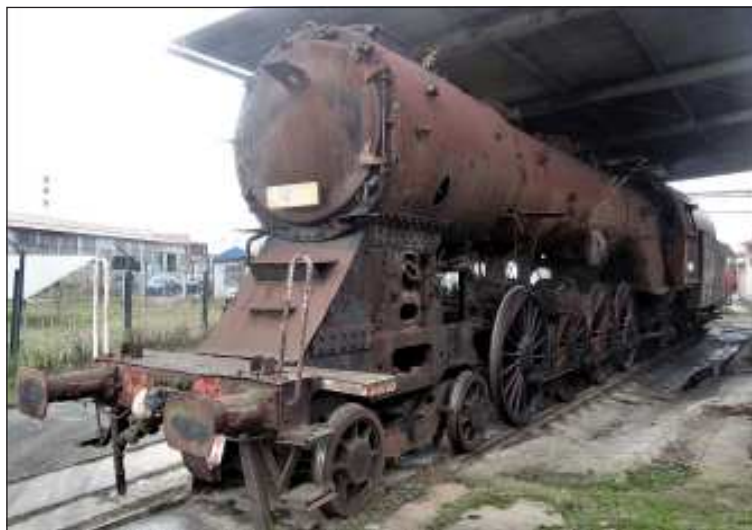
Parní lokomotiva 498.112 při první údržbě a očištění v českolipském depu.
